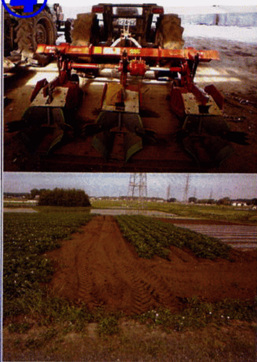
写真右上：大豆用培土機を改造して、ジャガイモ用の培土板を溶接
